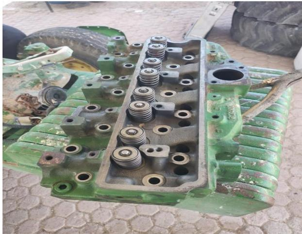
**Figura 64.** Reparación de motor tractor John Deere 6425
