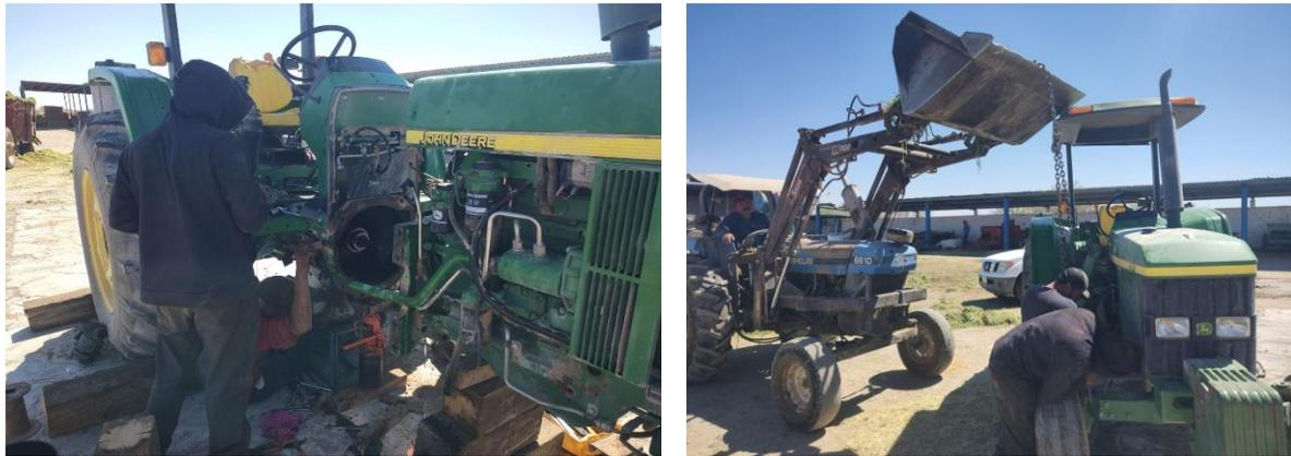
**Figura 66.** Cambio de flecha de transmisión del tractor John Deere 6403
